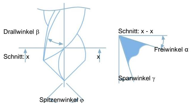
Abb. 5: Bohrer für Vivak<sup>®</sup> und Axpet<sup>®</sup> Platten
