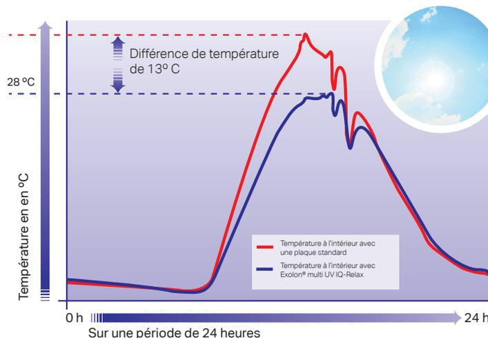
Des test réels menés dans des vérandas non ventilées ont permis d'observer une baisse de chaleur significative pouvant aller jusqu'à 13°C, en comparaison avec les plaques en polycarbonate standard. Il s'agit là d'un excellent résultat garantissant une température ambiante agréable non tributaire du temps qu'il fait dehors. Ce gain de luminosité extraordinairement homogène offre une « ambiance lumineuse » confortable.
