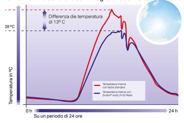
Gli esperimenti effettuati in condizioni reali in verande coperte non ventilate hanno evidenziato una notevole riduzione termica fino a 13 °C rispetto alle lastre standard. Questo eccellente risultato garantisce una piacevole temperatura ambientale indipendentemente dalle condizioni atmosferiche. L'effetto straordinariamente omogeneo crea una piacevole "atmosfera luminosa".
