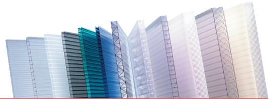
**Makrolon® multi UV 4/10-6** est une plaque en polycarbonate quadruple paroi d'une épaisseur de 10 mm. Elle combine transmission élevée de la lumière, excellente isolation thermique et propriétés porteuses remarquables grâce à la structure en Y. La plaque est légère, résistante aux chocs et très facile à poser.
