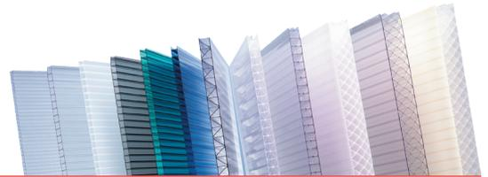
**Makrolon® multi UV 5M/32-20** est une plaque en polycarbonate d'une épaisseur de 32 mm, dotée d'une structure en M pour une rigidité améliorée. Elle combine propriétés porteuses remarquables, excellente isolation thermique, transmission élevée de la lumière et excellente résistance aux intempéries. La plaque est légère, résistante aux chocs et très facile à poser.
