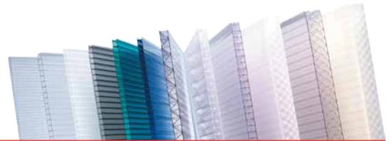
Il **Exolon® multi UV 5M/40-20** è una lastra alveolare di 40 mm di spessore in polycarbonato con sezione ad M che ne migliora la rigidità. Le caratteristiche della lastra permettono di combinare una buona capacità di portata con un ottimo isolamento termico, trasmissione di luce ed un'eccellente resistenza agli agenti atmosferici. La lastra è, inoltre, leggera, resistente agli urti e facile da montare.
