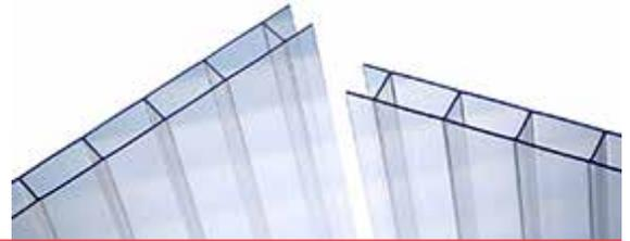
**Exolon® multi UV 2/16-30** est une plaque double paroi en polycarbonate d'une épaisseur de 16 mm. Elle associe une transparence élevée et un bon transfert de charge avec une bonne isolation thermique et une excellente résistance aux intempéries. La plaque est légère, résistante aux chocs et simple à poser.
