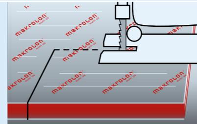
**9** | Oft ist ein Eckausschnitt nötig (z.B. für Rohrleitungen, Lüftungen usw.). Verwenden Sie eine Stichsäge ohne Pendelhub. Für Bohrungen können Sie Spiralbohrer (Spitzwinkel  $\phi$  110°-130°), Kegel oder Stufenbohrer verwenden.
