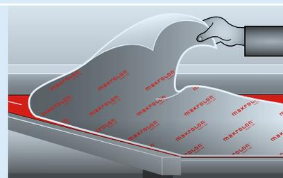
**13** | Am Schluss entfernen Sie die Schutzfolie von den Makrolon® multi UV Platten die nicht länger als 24 Stunden unter Witterungsbedingungen bleiben soll, ...
