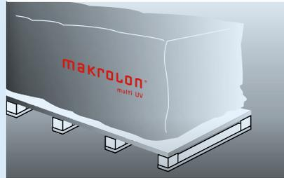
**1** | Die Platten sollten möglichst horizontal und in Innenräumen gelagert werden. Bei Außenlagerung decken Sie die Makrolon® multi UV Platten mit weißer Polyethylen (PE)-Folie ab.
