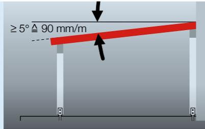
**2** | Wir empfehlen Ihnen eine Dachneigung von mind. 5° ( $\triangleq$  90 mm/m). So fließt das Regenwasser besser ab, die Verbindungen bleiben dicht und eine natürliche Reinigung durch das Regenwasser ist gewährleistet.
