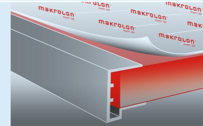
**10** | Für das Verschließen der Plattenstirnseiten gibt es eine einfache, aber sehr wichtige Regel, um die Kondensatbildung möglichst gering zu halten: **oben so dicht wie möglich** (z.B. Abkleben der Kante mit Aluminiumband und Aufstecken eines Aluminium-Abschlussprofils, eventuell mit
