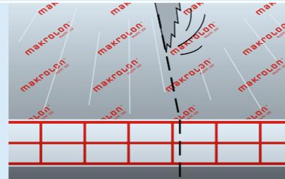
**8** | Werden die Makrolon® multi UV Platten in ihrer Breite reduziert, sägen Sie bitte möglichst nahe am nächsten Steg, um die optimale Klemmwirkung des Profils zu gewährleisten.
