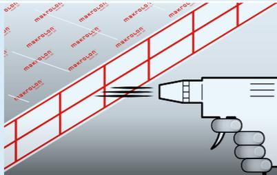
**7** | In die Platte eingedrungene Sägespäne entfernen Sie mit Druckluft oder einem Staubsauger.
