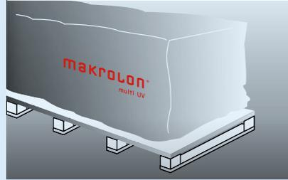
**1** | Les plaques doivent si possible être stockées à plat et en intérieur. En cas de stockage en extérieur, recouvrez les plaques Makrolon® multi UV d'un film plastique blanc en polyéthylène (PE). Choisissez une ossature porteuse sans torsion. L'idéal est de choisir des poutres collées en lamellé ou des ossatures porteuses métalliques avec des chevrons longitudinaux.
