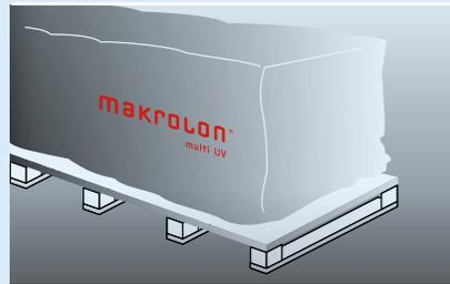
**1** | Immagazzinare le lastre in posizione orizzontale in ambienti coperti. In caso di stoccaggio all'esterno, coprire le lastre Makrolon® multi UV con fogli di polietilene bianco (PE). Scegliere come base di appoggio una struttura sufficientemente rigida. Ideali sono strutture in legno lamellare o costruzioni in metallo con travi longitudinali, su cui vengono montati i profili di fissaggio.
