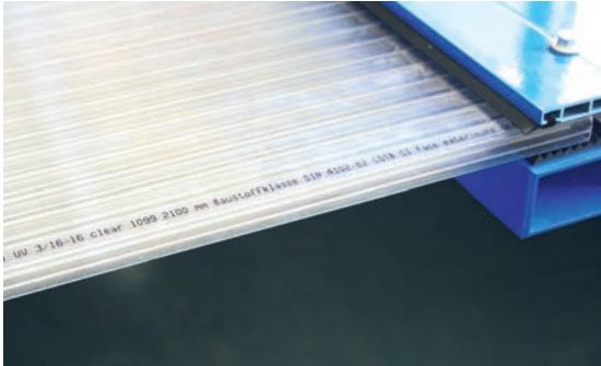
Der Tintendrucker markiert die UV-geschützte Seite der Platte.
