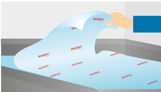
Entfernen Sie die Schutzfolie sofort nach der Montage
