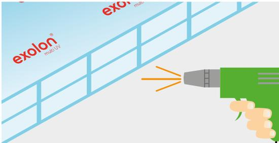
Entfernen Sie Späne nach dem Schneiden.
