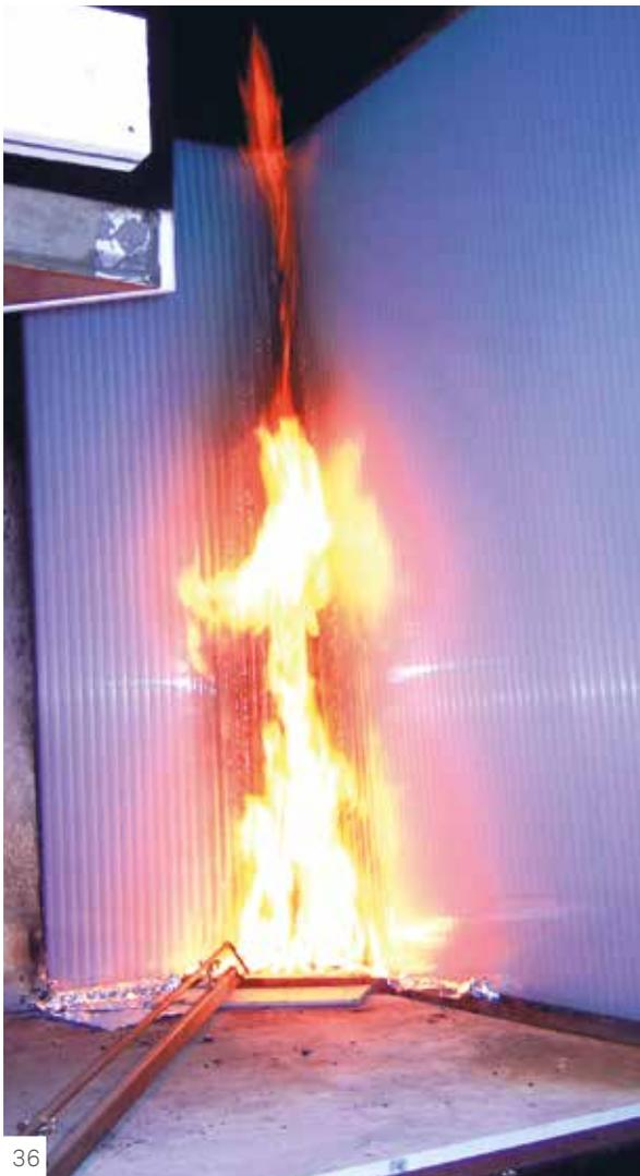
Im Brandfall wird die Platte weicher werden, reißen und von der Hitzequelle weg-schrumpfen, wodurch eine Öffnung entsteht, durch die der Rauch entweichen kann.
