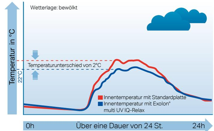
Die Stegplatte passt sich an die Klimabedingungen an, und die wärmedämmenden Eigenschaften werden von selbst aktiv, während ein Verlust der Lichtdurchlässigkeit auf ein Minimum begrenzt wird.
