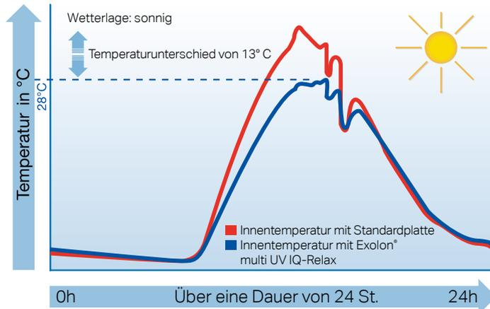
Entwicklung der Innentemperatur in einem nicht belüfteten/ungeheizten Wintergarten an einem sonnigen Tag. Die Stegplatte reflektiert die Sonnenstrahlen und reduziert die Wärmeentwicklung im Raum um mehr als 46%.
