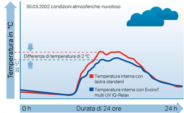
La lastra alveolare si adatta alle condizioni climatiche e le proprietà di isolamento termico si attivano da sé, mentre la perdita di trasmissione luminosa viene ridotta al minimo.
