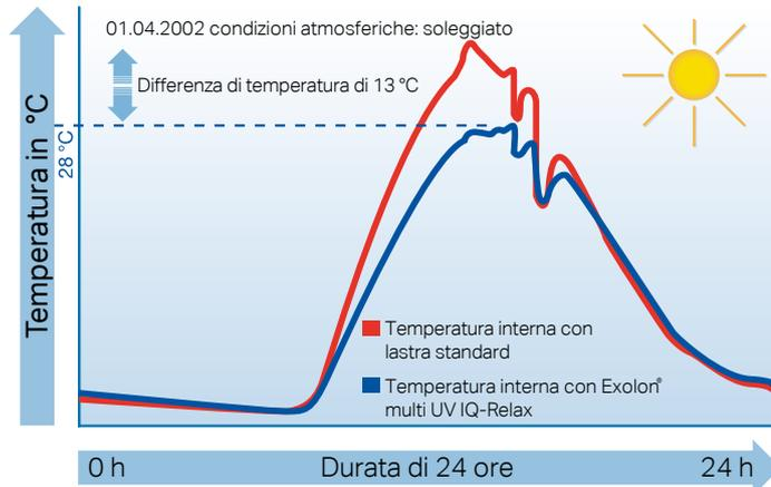
Sviluppo della temperatura interna in un giardino d'inverno non ventilato/riscaldato durante una giornata di sole. La lastra alveolare riflette i raggi solari e riduce lo sviluppo del calore nell'ambiente di oltre il 46%.
