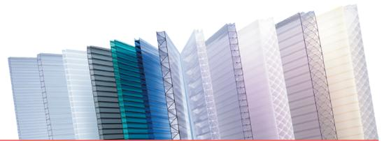
**Makrolon® multi UV 7M/40-28** est une plaque en polycarbonate d'une épaisseur de 40 mm, dotée d'une structure en M pour une rigidité améliorée. Elle combine propriétés porteuses remarquables, excellente isolation thermique, transmission élevée de la lumière et excellente résistance aux intempéries. La plaque est légère, résistante aux choc set très facile à poser.
